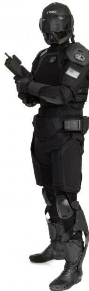
Комплект Mounted Warrior включает: компьютер, нашлемный дисплей (HMD), GPS-навигатор, радиостанцию, блок питания и систему управления вооружением. Солдат может вести наблюдение за полем боя благодаря видео и инфракрасной камерам, закрепленным на автоматической винтовке, изображение от которых отображается на дисплее.
